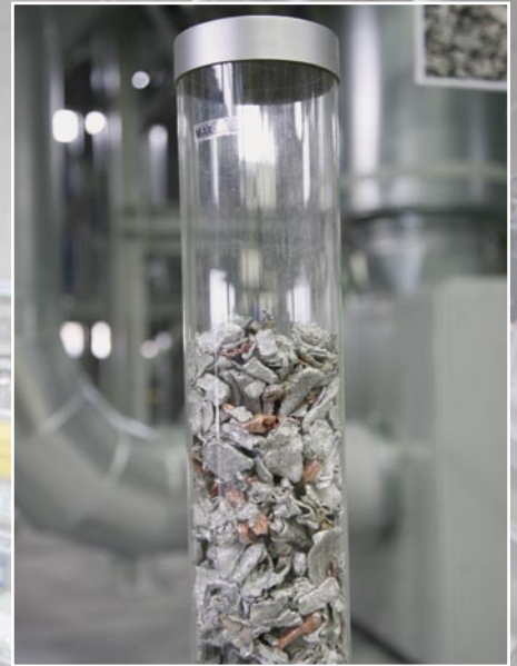
Sortenreiner Output: Aluminium und Kupferfraktion.
