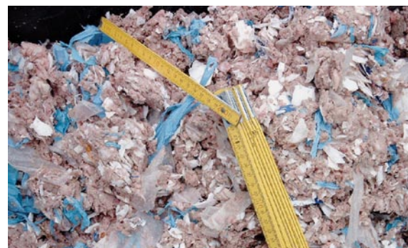
Output: Perfekt aufbereitetes Substrat. Die Kunststoffe lassen sich leicht separieren.
